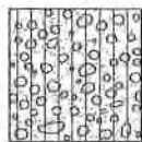
gSM SILTY, GRAVELLY SAND
