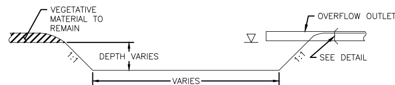
SEDIMENT POND DETAIL SCALE: 1"=10'
